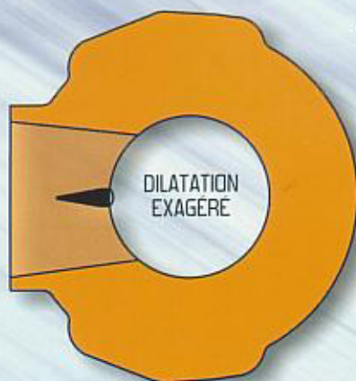
Fig 24/11 DILATATION DU CONDUIT D'ÉCHAPPEMENT
