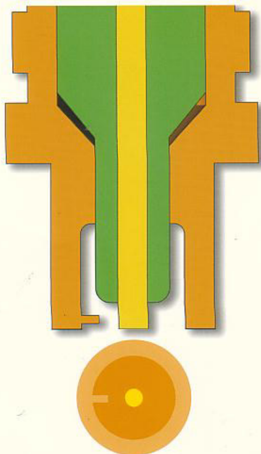
FIG 9/6 BOUGIE RACING À ÉLECTRODE LATÉRALE INTERNE
