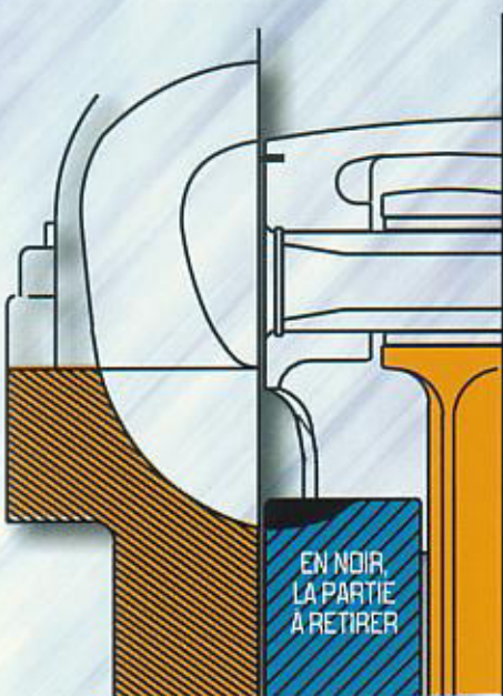
Fig 3/13 RECTIFICATION DU VOLANT EN CAS DE DIFFÉRENCE DE HAUTEUR AVEC LA LUMIÈRE DE TRANSFERT
