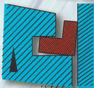
Fig 4/15 INCLINAISON D'UN SEGMENT DE COMPETITION
