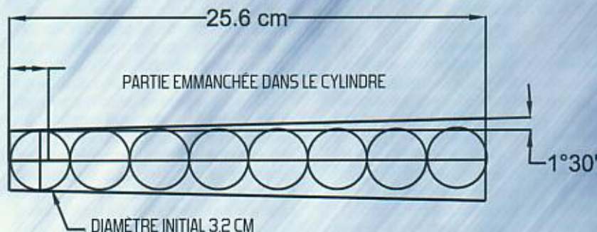
Fig 2/12 CALCUL DU PREMIER CÔNE D'ÉCHAPPEMENT
