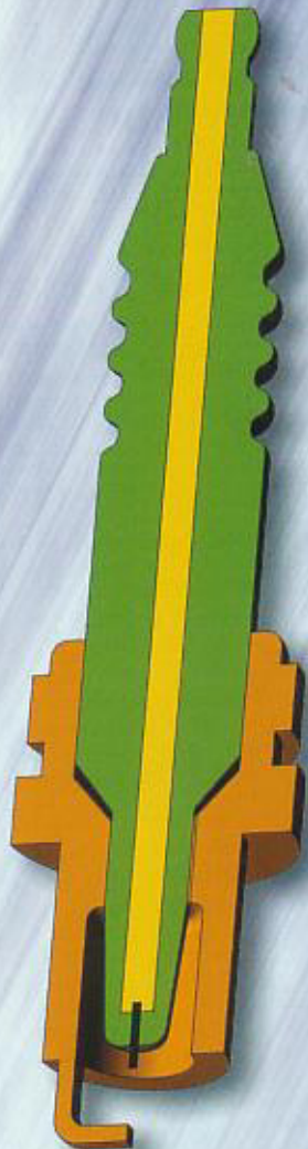
FIG 11/6 BOUGIE À ÉLECTRODE CENTRALE EN MÉTAL PRÉCIEUX
