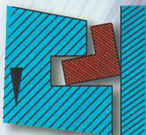
Fig 2/15 FONCTIONNEMENT DU SEGMENT EN L
