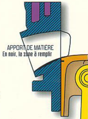
FIG 28/11 MODIFICATION DE LA LUMIERE PRINCIPALE
