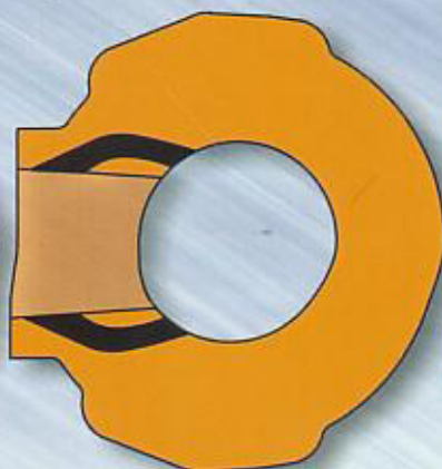
Fig 25/11 LUMIÈRE D'ÉCHAPPEMENT SECONDAIRES (BOOSTERS)
