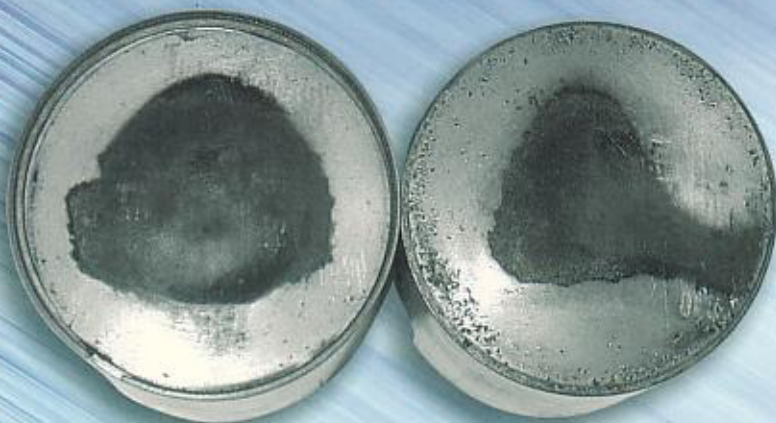
LE DÉPÔT DE CALAMINE EST DIFFÉRENT SELON LE PROFIL DES TRANSFERTS
