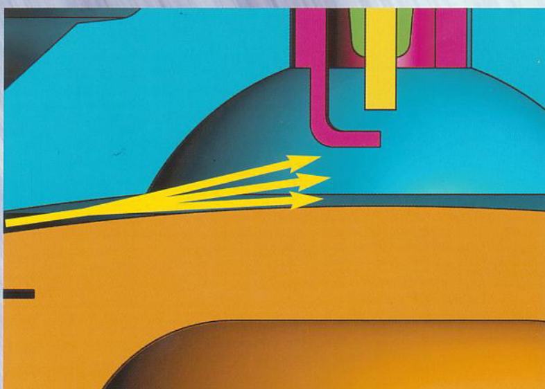
FIG 16/4 FORME PARABOLIQUE DE LA ZONE DE SQUISH
