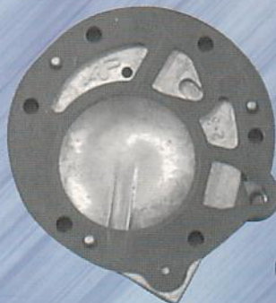
PHOTO 5/5 CARBURATEUR DE KART DEMONTÉ
