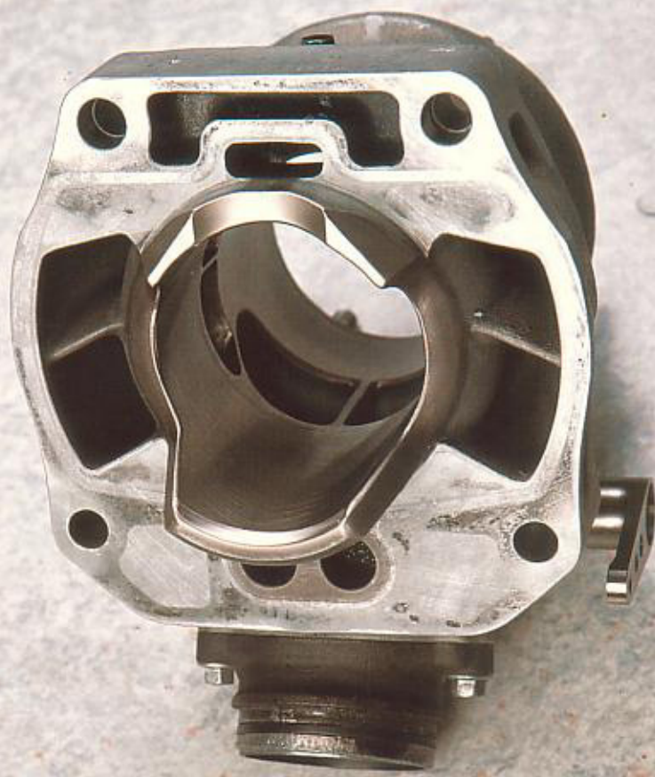
CYLINDRE DE NSR 500 Notez le profil de la chemise au niveau des transferts
